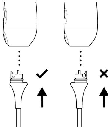
**Figura 7. Espacio esperado entre el protector antitorsión del cable y la sonda tras conectar el cable de Butterfly iQ3**
