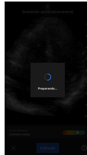
6. Si la herramienta de cálculo automático de FE puede calcular una fracción de eyección, se mostrará la pantalla de resultados de fracción de eyección automática y la fracción de eyección calculada se marcará como medición automática con el método de Simpson. Puede guardar este resultado automático, modificar el resultado y volver a calcularlo, o eliminar el resultado y la secuencia.
