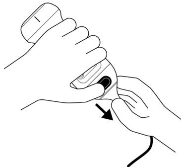
2. Alinee el conector y la sonda e inserte el cable en la sonda con firmeza. Cuando el cable esté completamente instalado, sentirá un ligero "clic" cuando el dispositivo de bloqueo del cable de la sonda encaje con el cable.
