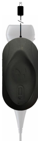
Figur 3. Tredje generation sondeoplader
