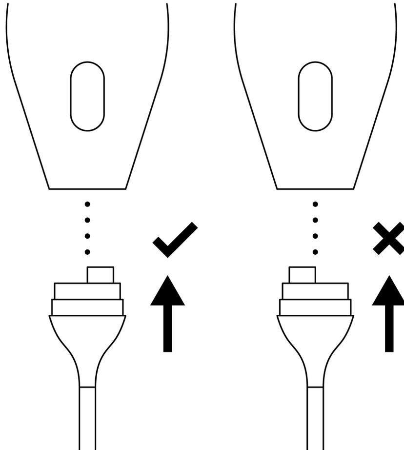
**Figure 9. Espace entre le serre-câble du câble et le corps de la sonde après avoir fixé le câble du Butterfly iQ+ Vet.**
