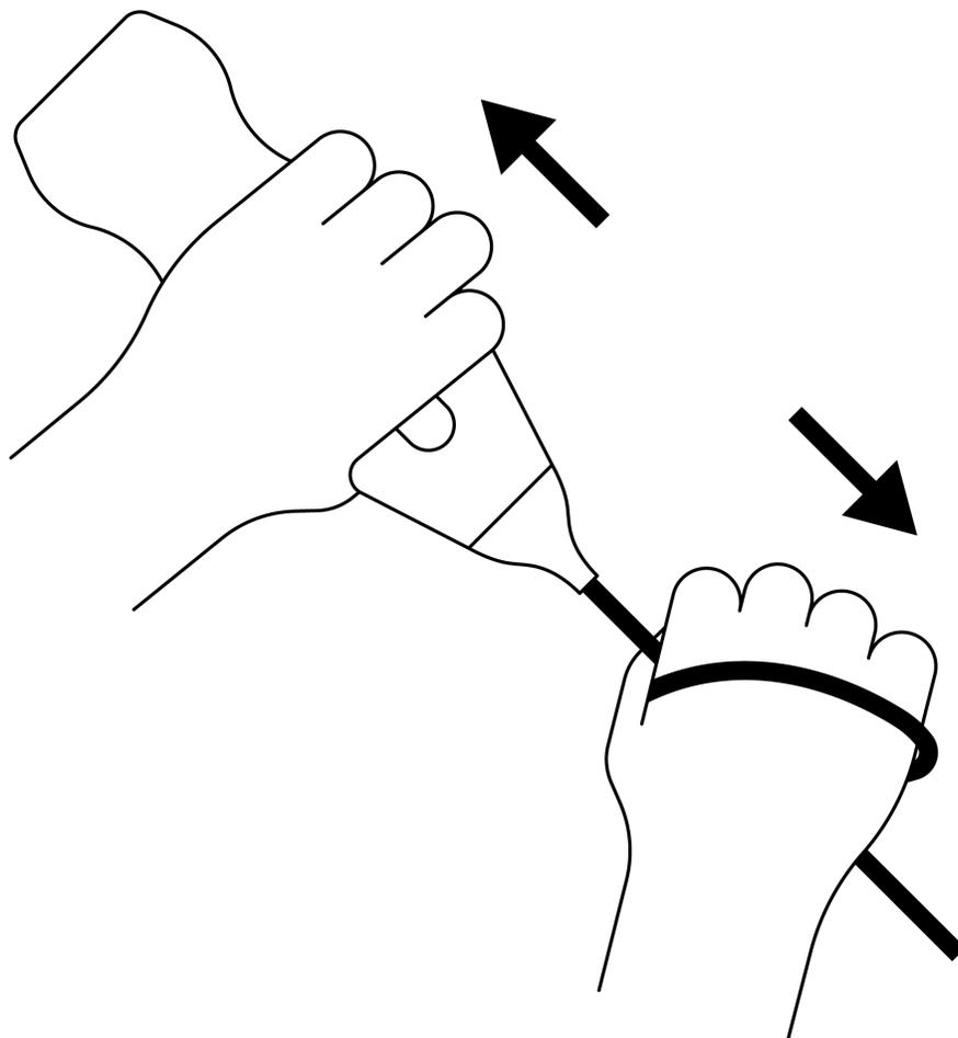
2. Aligner le connecteur et la sonde, et pousser le câble fermement dans le corps de la sonde. Lorsque le câble est correctement fixé, il doit normalement rester un petit espace entre le serre-câble et le corps de la sonde.
