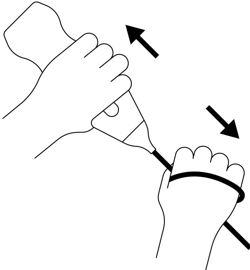
2. Richten Sie den Anschluss und die Sonde aus, und drücken Sie das Kabel fest in den Sondenkörper. Nach der vollständigen Installation des Kabels ist damit zu rechnen, dass ein kleiner Spalt zwischen der Zugentlastung und dem Sondenkörper verbleibt.
