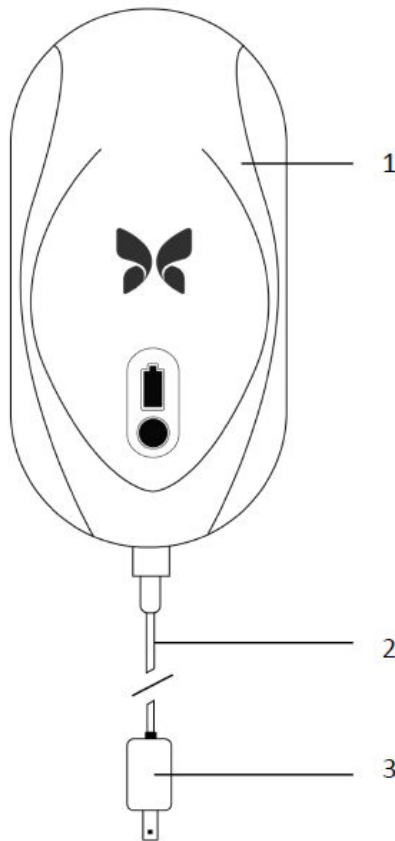
Figura 2. Componenti della base di ricarica
