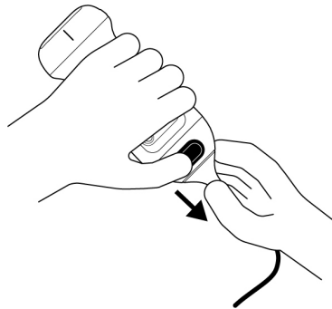
Kuva 8. Butterfly iQ3 -kaapelin irrottaminen
