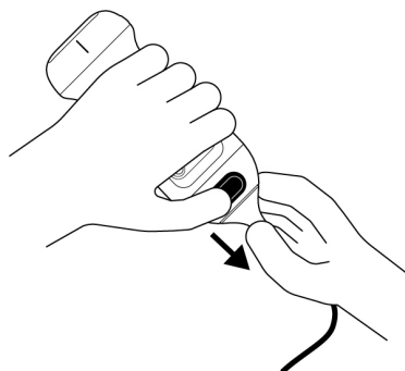
Figur 8. Fjernelse af Butterfly iQ3 kabel
