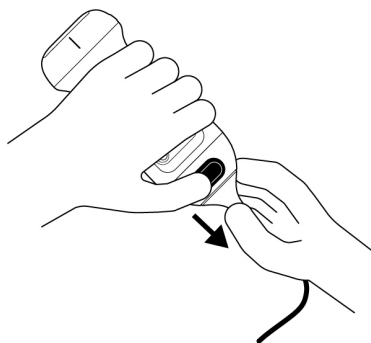
Figura 8. Remover o cabo Butterfly iQ3
