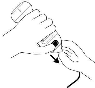
2. Richten Sie den Anschluss und die Sonde aus, und drücken Sie das Kabel fest in den Sondenkörper. Wenn das Kabel vollständig installiert ist, spüren Sie ein leichtes „Klicken“, wenn die Kabelverriegelung an der Sonde am Kabel einrastet.
