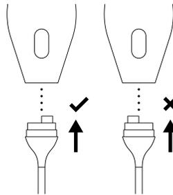
**Figure 9. Espace entre le serre-câble du câble et le corps de la sonde après avoir fixé le câble du Butterfly iQ+**
