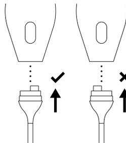
**Figura 9. Espacio esperado entre el protector antitorsión del cable y la sonda tras conectar el cable del Butterfly iQ+**
