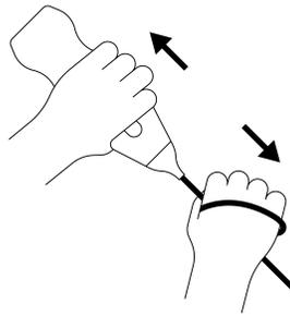
2. Alinee el conector y la sonda e inserte el cable en la sonda con firmeza. Cuando el cable esté bien conectado, debería quedar un pequeño espacio entre el protector antitorsión y la sonda.
