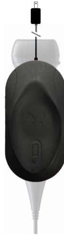
Abbildung 3. Sondenladegerät der 3. Generation
