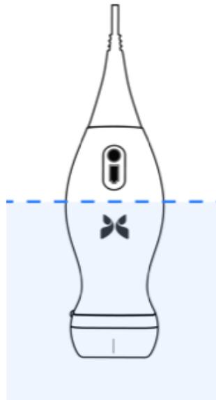
3. Sumerja la sonda en la solución Cidex<sup>®</sup> OPA hasta la línea de inmersión y compruebe que no queda aire ni burbujas. Déjela en el agua el tiempo que se indique en las instrucciones del fabricante.
